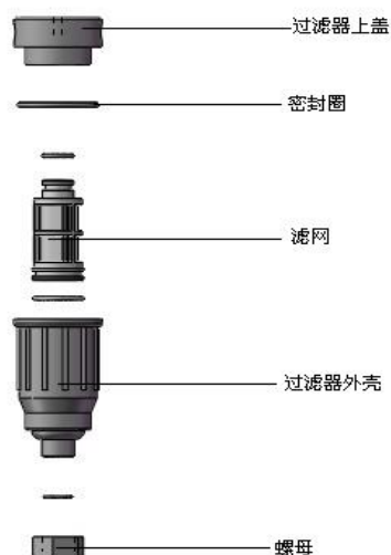
Схематическое изображение водяного фильтра
